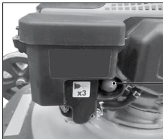
Кнопка подкачки топлива
